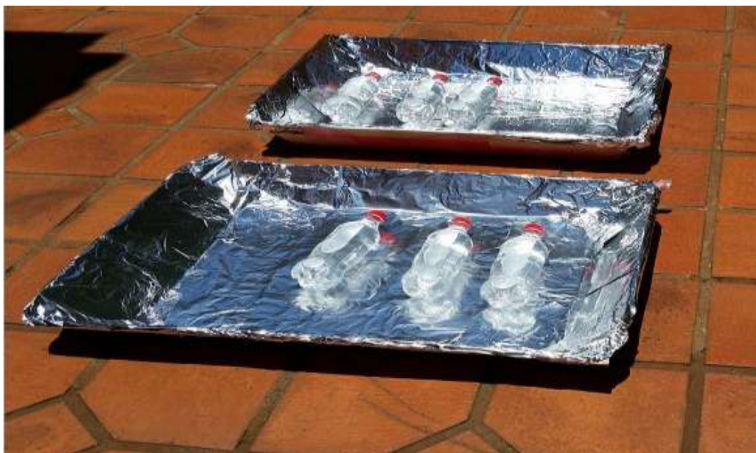
Figura 4: Execução do experimento: garrafas expostas à radiação solar com o uso de concentrador solar.
